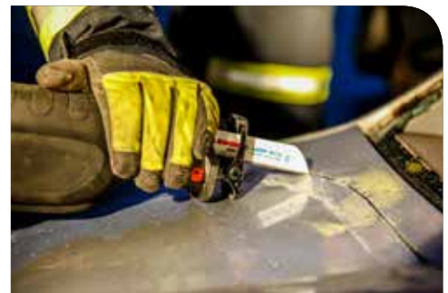
Mit den hochbelastbaren Säbelsäge-Blättern von LENOX ist ein wesentlich rascheres und effizienteres Arbeiten im Einsatz möglich. Der Umgang will dennoch geübt sein.
