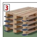
**3. als Zwischenlagensicherung zwischen Ladegutträger und Ladegut**
